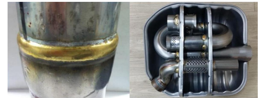
Obr. 9 Spájkované spoje častí výfuku a vnútornej časti hlavného výfuku [15] Fig. 9 Brazed joints of the exhaust part and the inner part of the main exhaust
