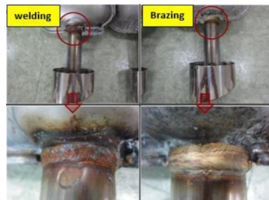
Obr. 8 Výsledok testu koróznej odolnosti spoja v slanej vode po zváraní/spájkovaní [15] Fig. 8 The result of the corrosion resistance test of the joint in salt water after welding/brazing
