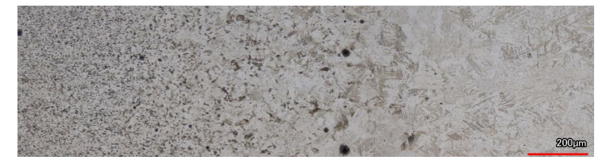
Obr. 5a Průběh mikrostruktury od základního materiálu (vlevo) přes TOO (střed) po svarový kov (napravo) materiálu S355J2 Fig. 5a Change of microstructure from base material (left) to HAZ (center) to fused metal (right) of S355J2
