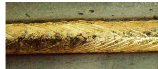
Obr. 9 Laserový pájený spoj bronzovým drátem Fig. 9 Laser brazed joint with bronze wire
