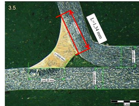
Obr. 10 Řez pájeným spojem zadního víka Škoda Superb laserem Fig. 10 Cut through the soldered joint of the Škoda Superb rear cover with a laser
