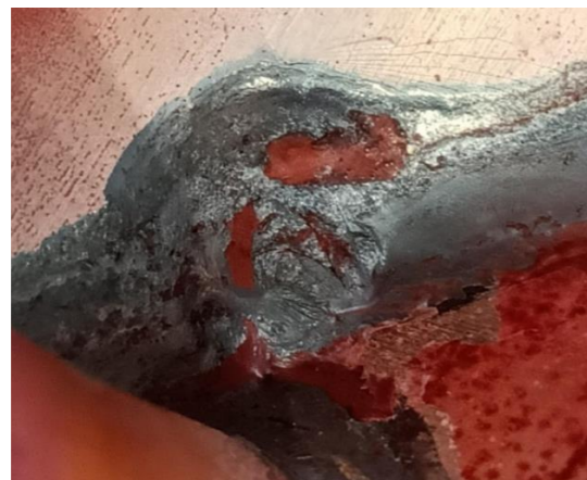
Obr. 7 Natavení základního materiálu Fig. 7 Melting of the base material
