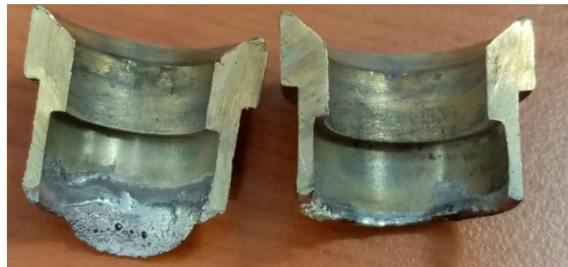
Obr. 6 Nedostatečná pájecí mezera Fig. 6 Insufficient solder gap
