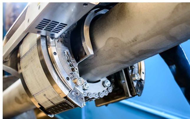
Automatizovaná prenosná frézovacia hlava ATF-150
