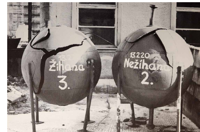
Zvárané guľové nádoby z ocele akosti 13 220 po tlakovej skúške do deštrukcie (Ø 1350 mm)
