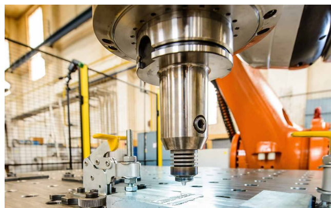
Robotické testovanie nástroja na trecie zváranie s premiešaním
