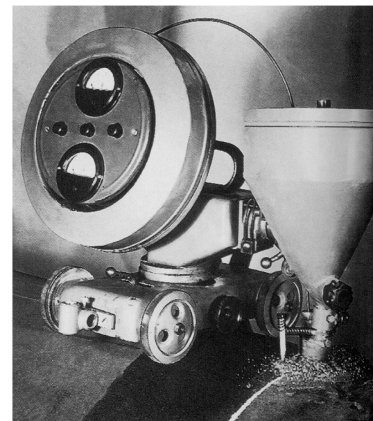
Traktor VÚSČA – prvé zariadenie na zváranie pod tavivom
